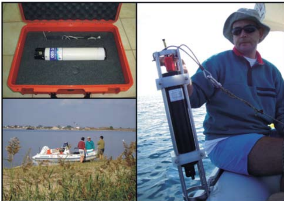
Σχήμα 2. Το θολερόμετρο OBS, το CTD, και φωτογραφίες από τη δειγματοληψία.
